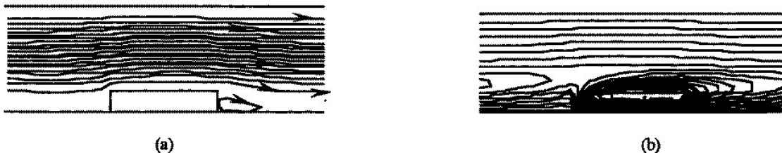
Figura 4.- (a) 20 Líneas de Corriente (+) Igualmente Espaciadas y una (-); (b) 20 Líneas Isotermas Igualmente Espaciadas. \theta_{max} = 2.86 en *; ( Re = 100 , \bar{Q} = 1000 , sin radiación)
